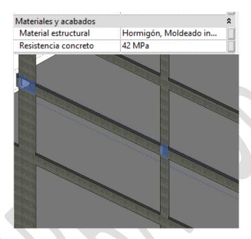
También se le asigna la propiedad / Disallow join (no permitir unión) en ambos extremos de la viga lo cual permite que los nudos NO se una al elemento adyacente, sea columna, muro u otra viga, de esta manera el volumen de concreto no se duplica a la hora de cuantificar volúmenes.
